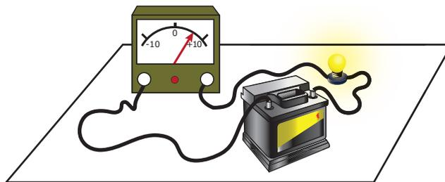
Se o sentido da corrente for invertido, o torque magnético será oposto ao mostrado anteriormente. Assim, o ponteiro gira para a esquerda. Esse tipo de galvanômetro, além de medir o valor da corrente, determina o sentido desta no circuito.
