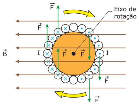
Nessa figura, foram indicadas apenas algumas forças para não poluí-la. Nos motores comerciais, o campo magnético é radial ao eixo do motor (o ímã tem forma curva acompanhando o rotor). Assim, cada espira fica submetida a forças perpendiculares aos fios, o que aumenta o torque.
