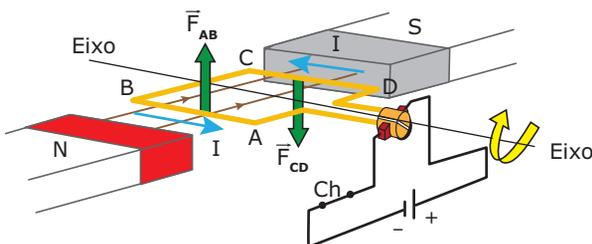
Devido às forças  $\vec{F}_{AB}$  e  $\vec{F}_{CD}$ , a espira sofre um torque (binário de forças) no sentido horário e começa a girar em torno do eixo nesse sentido. Esse é o princípio básico de funcionamento dos motores elétricos e dos medidores (galvanômetro) de quadro móvel, descritos a seguir.
