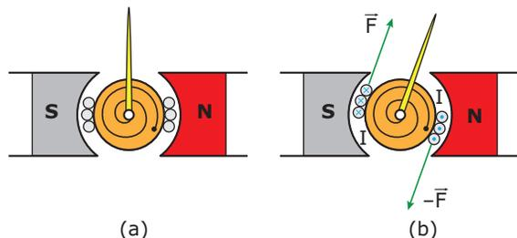
Na figura (b), uma corrente entra no aparelho pelos fios da esquerda. O torque aplicado pela força magnética gira o ponteiro no sentido horário. Agora, a mola está deformada e exerce um torque em sentido oposto. No momento em que os torques se equilibram, o ponteiro se estabiliza e a leitura pode ser feita na escala do instrumento, conforme a figura a seguir:
