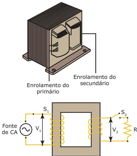
Quando uma tensão alternada  $V_1$  é aplicada no circuito primário, uma tensão  $V_2$ , também alternada, é induzida no circuito secundário. Para  $N_2 > N_1$ , a variação de fluxo magnético no circuito secundário é grande, e a tensão de saída  $V_2$  é maior que a tensão de entrada  $V_1$ . Para  $N_2 < N_1$ , ocorre o inverso, isto é, a tensão  $V_2$  é menor que  $V_1$ .
