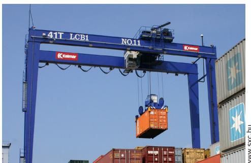
Dois motores distintos podem erguer o contêiner da figura anterior, a uma mesma altura  $h$ , em tempos diferentes. Ambos realizam o mesmo trabalho ( $W = Ph$ ), porém uma máquina o realiza em menos tempo. Dizemos, então, que as máquinas apresentam potências diferentes. A potência é uma grandeza física que mede a rapidez com a qual uma força realiza trabalho, isto é, o ritmo no qual um sistema transfere energia para outro. Matematicamente, podemos escrever que:
