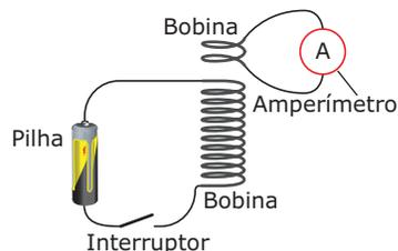
Ele liga uma das bobinas em série com a pilha e com o interruptor, inicialmente, desligado. A outra bobina, ele a conecta ao amperímetro e a coloca próximo à primeira. Em seguida, Rafael liga o interruptor no instante  $t_1$  e desliga-o no instante  $t_2$ . Assinale a alternativa cujo gráfico **MELHOR** representa a corrente no amperímetro, em função do tempo, na situação descrita.
