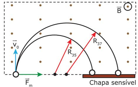
A força magnética que atua sobre todas as partículas é a mesma ( $F_m = Bqv_0$ ). O raio da trajetória de cada um dos isótopos, porém, é diferente ( $R \propto m$ ). Os isótopos são detectados numa chapa sensível à colisão de cada um deles. Revelando a chapa e medindo a densidade de colisões em cada ponto, é possível detectar a quantidade de cada um dos isótopos. Assim, fazendo uma média ponderada das massas dos isótopos, conclui-se que a massa atômica aproximada do cloro é 35,5 u.
